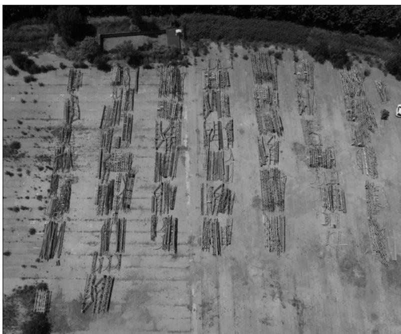
figure 16 · démontage sélectif de la structure métallique de la Halle Lustucru à Arles (a). Les éléments sont triés au sol (b).
